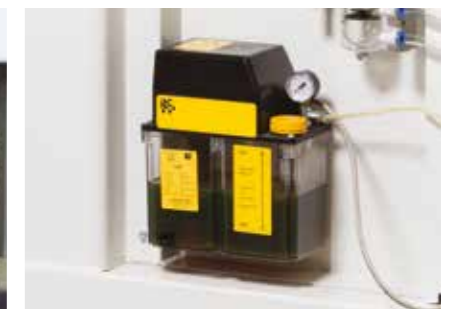
Sistema de engrase centralizado y automático. Centralised, automatic lubrication system. Système de lubrification centralisé et automatique. Sistema de lubrificação centralizada e automática.
