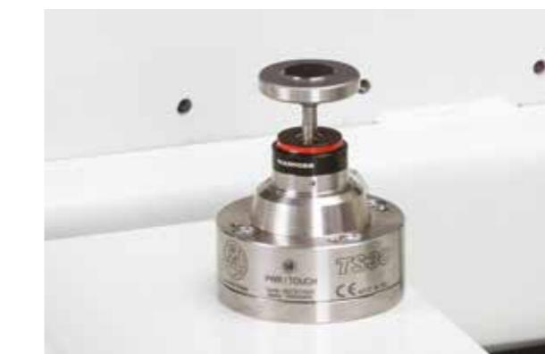
Medidor de herramienta por contacto "MARPOSS" TS 30.
